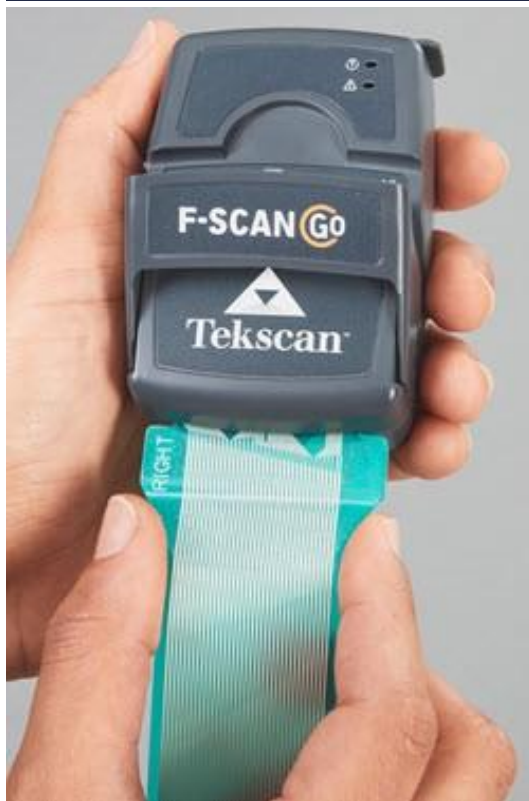
図 52 – TekDAQ に取り付けられたセンサ
