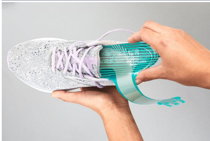
図 55 – 靴の中にセンサを取り付ける
