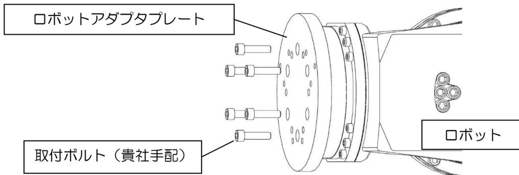
図 6. ロボットアダプタプレートの取付
