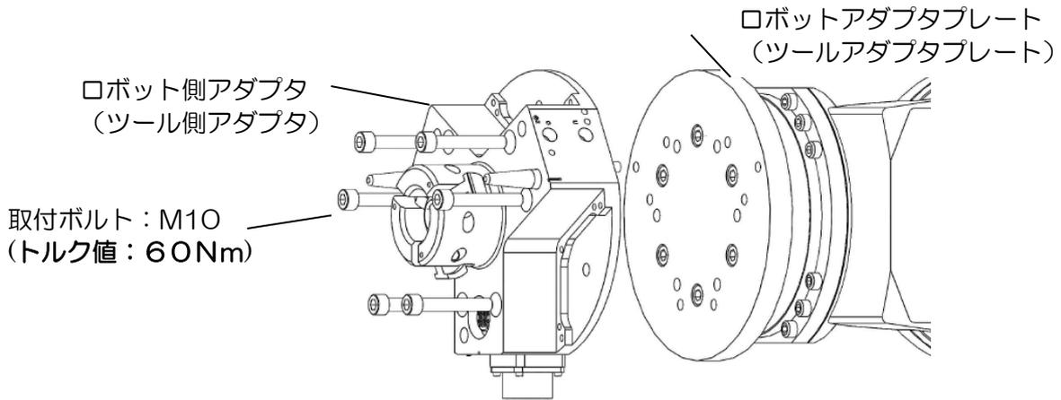
図 7. ロボットアダプタの取付
