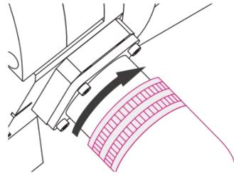
ロボット動作時にコネクタが外れないように最後まで確実に締めてください。
