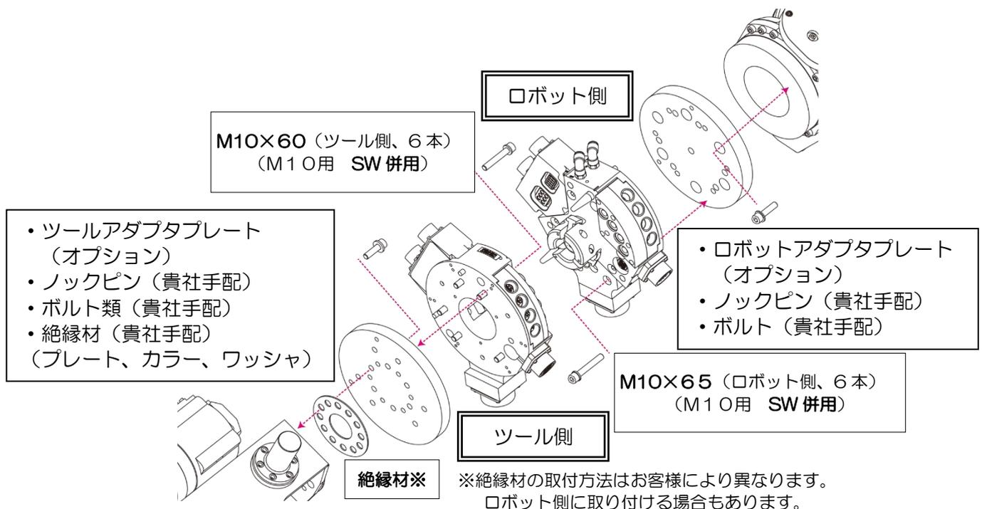
図 5. ロボット及びツールの組立図
