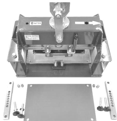
② ベルトクランプ、ベルトクランプ締め付けボルト、ベルトクランプフロートバネ、カッティングシートを取り外す。
