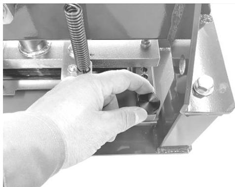
① ベルトクランプの締め付けボルトを緩める。
