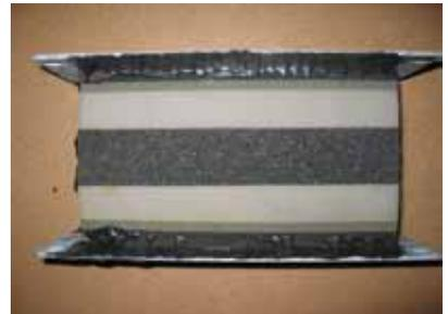
止水試験の供試体外観
