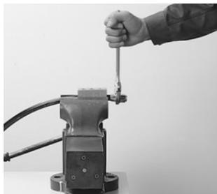
ソケットをホース端部に入れ、反時計方向に手でねじ込み、適正なモンキーレンチを使用して、ソケットをホースのマーク位置までゆっくりとねじ込みます。ソケット内側端面とホースの先端に約2～3mmぐらいのすき間があるか確認してください。
