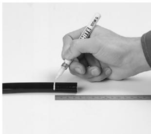
継手に挿入するホース長さをスケールで計り、その位置に白ペンを使ってホースにマークします。
