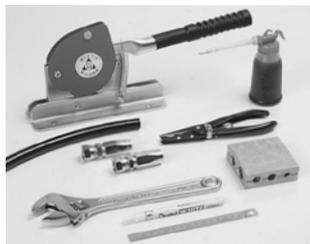
使用条件に適したホースおよび継手、ホースカッター、ホールディンググダイ、潤滑油※、モンキーレンチ、白ペンを用意します。
