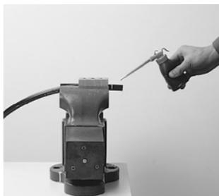
ホースをホールディングダイにはさみ、ソケットにねじ込むホース長さ分だけホールディングダイから突き出して、バイスに固定します。ねじ込みを容易にするため、ホース端面表面に潤滑油を塗布してください。
