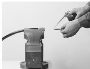
バイスおよびホールディングダイよりアセンブリを取り出します。ソケットをバイスにはさみ、ニップルのねじ部とホース内部に潤滑油を十分に塗布してください。
