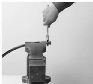
時計方向にニップルを手でねじ込み、適正なモンキーレンチを使用して、ニップルの六角部分がソケットに接触するまで、ゆっくりとねじ込みます。
