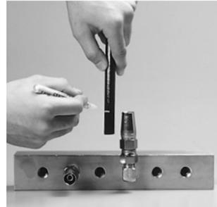
図のように、ホース端部を継手ソケットの円周溝に合わせ、白ペンを使ってホースにマークします。
