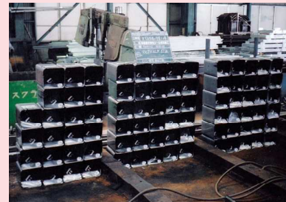
施工後大量の空缶が発生する弾性シール材
