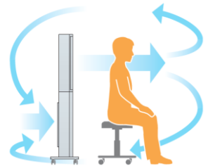
【個室でのクリーンエアーの循環】
