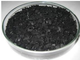
酸性ガス除去用吸着剤「ギガコール HC™」 吸着原理▷活性炭で物理吸着した後に添着剤で中和反応
